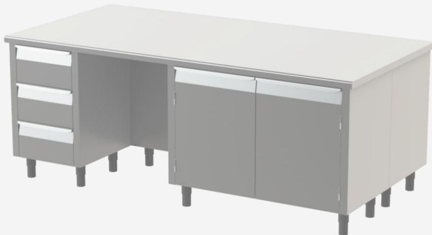
Fabricado en acero inoxidable AISI 304 Cr-Ni 18/10, acabado Scotch Brite. Espesor de la encimera 1,20mm con refuerzo interno y taponamiento de acero inoxidable inferior. Borde frontal redondeado R10, lateral R2.
