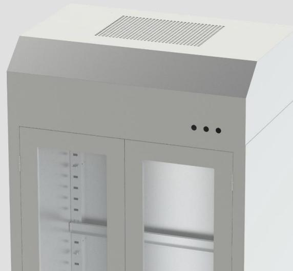
Réalisé en acier inoxydable AISI 304, finition extérieure Scotch Brite. Avec deux portes battantes avec cadre en acier inoxydable et verre de sécurité de 3+3 mm ou polycarbonate transparent de 6mm, avec 3 étagères intérieures perforées réglables en hauteur, en acier inoxydable AISI 316. Sur pieds réglables avancés à l'arrière pour congé d'angle. Toit incliné avec unité de filtration H14 à l'intérieur, 595x595x425Hmm
