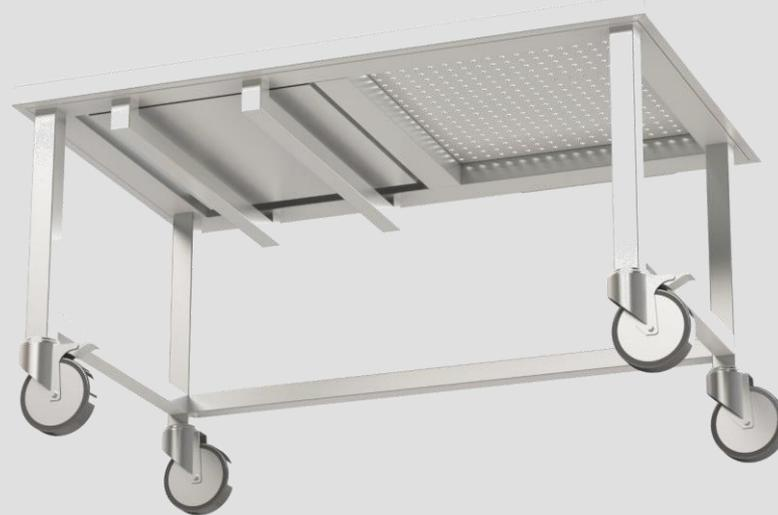
Structure en acier inox AISI 304, tube carré de 40x40mm, épaisseur 1,00mm, entièrement soudée et avec jambes postérieures avancées à 80mm pour congé d'angle.
