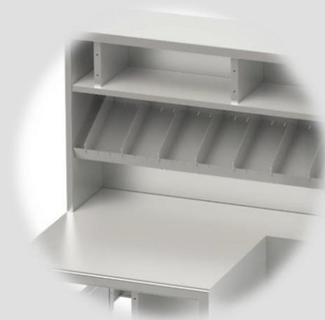
Structure en acier inox AISI 304, tube carré de 40x40mm, épaisseur 1,00mm, entièrement soudée. Étagère inférieure et barres de renforcement positionnés entre l'étagère et le plan de travail, H=150mm, plus profond que la paillasse de 100mm pour permettre le logement des boîtes. Tablette rabattable dim. 400x900mm sur le côté gauche, capacité de charge 50kg. Sur pieds réglables.
