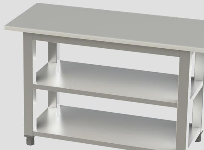
Structure en tube d'acier inoxydable AISI 304 mm40x40, épaisseur 10/10mm, entièrement soudée, finition Scotch Brite. Deux étagères pour chaussures soudées à la structure. Plan en HPL blanc 406/Zodia noir de 16mm d'épaisseur, arrondi R5 dans les angles. Sur pieds réglables.
