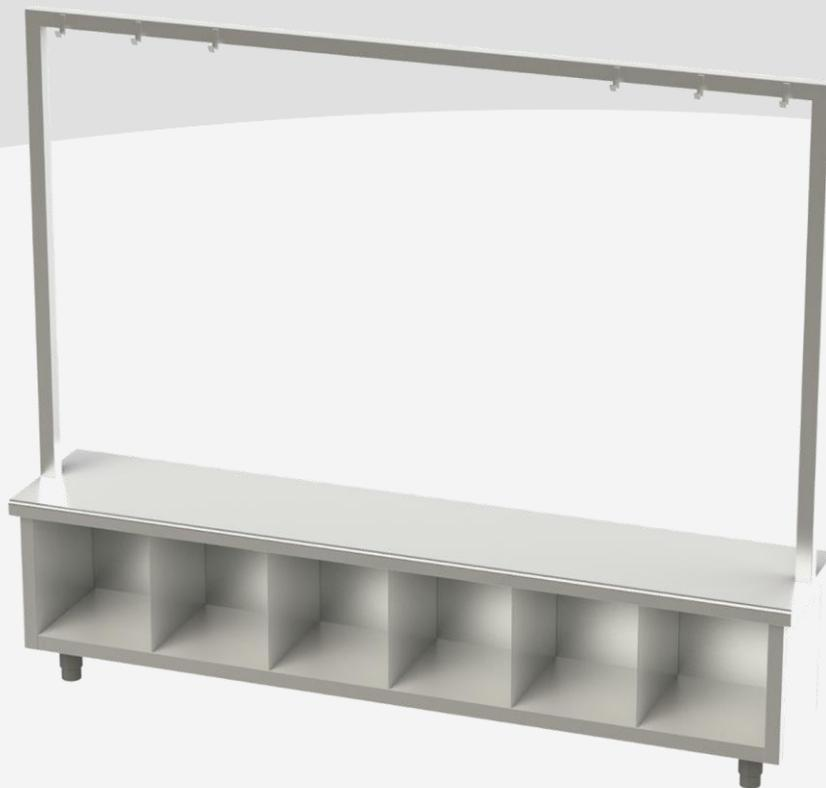
Struttura in tubo di acciaio inox AISI 304 mm40x40, sp.10/10mm, interamente saldata, finitura Scotch Brite. Pannelli laterali saldati a chiusura dei fianchi, divisori verticali identificano 6 vani accessibili da un solo lato. Piano di seduta in AISI 304 sp. 12/10mm con rinforzo interno e tamponamento inferiore in acciaio inox. Lati lunghi raggiati R10. Piedini di livellamento. Struttura superiore appendiabiti completa di ganci sagomati ad L, saldata ai fianchi della panca.
