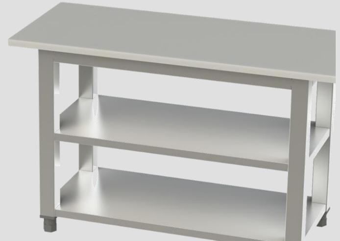
Struttura in tubo di acciaio inox AISI 304 mm40x40 sp.1mm interamente saldata, finitura Scotch Brite. Due ripiani porta scarpe saldati alla struttura. Piano di seduta in HPL bianco 406/nero zodia spessore 16mm, arrotondato R5 sugli angoli e bisellato sui lati. Piedini di livellamento.
