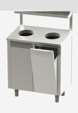
Composizione con struttura in tubo quadro mm40x40x1,00 in acciaio inox AISI 304, finitura Scotch Brite.
