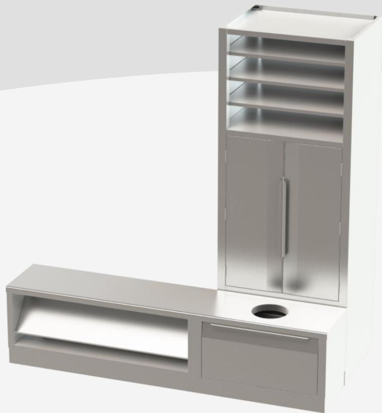
Panca realizzata con struttura in lamiera piegata di acciaio inox AISI 304, finitura Scotch Brite, su zoccolo portante inox H=100mm. A sinistra vano L=1200mm con porta scarpe doppio inclinato sui due lati e saldato alla struttura. A destra vano L=800mm con cassetto estraibile su guide inox e foro sulla seduta per l'inserimento dei panni sporchi. Piano di seduta in AISI 304 sp. 1,2mm con rinforzo interno e tamponamento inferiore in acciaio inox. Lati lunghi raggiati R10.
