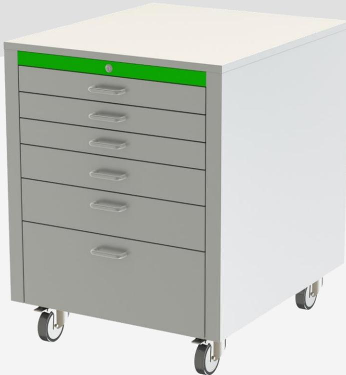
Réalisé en acier inoxydable AISI 304 Ni-Cr 18/10 avec finition Scotch Brite. 6 tiroirs dont 2 inférieurs H=300mm et 4 supérieurs H=150mm, avec fond perforé, amovibles, sur glissières en acier inoxydable, capacité 45 kg chacun, avec poignées à tige. Complet avec système de serrure centralisée à clé antibasculement. Sur roulettes tournantes électro-conductrices, Ø125mm, dont deux avec frein, avec support en acier inoxydable.
