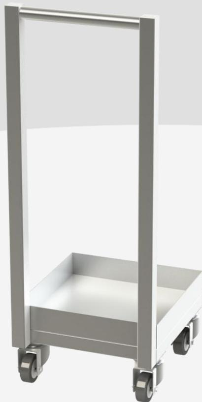
Réalisé en acier inoxydable AISI 316, finition Scotch Brite. Structure en tube carré 30x30mm, épaisseur 20/10. Étagère H=30mm avec rebord H=52mm. Poignée en tube rond Ø25mm. Hauteur de la poignée H=704mm, hauteur totale H=793. Sur roulettes tournantes.
