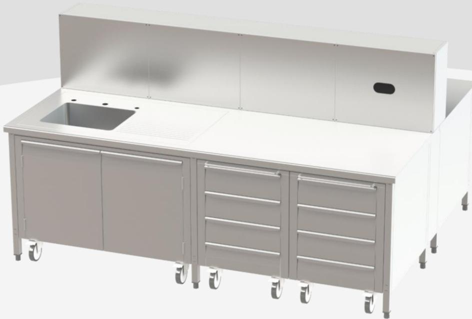
Encimera en AISI 304 sp. 1,20mm con refuerzo interno y taponamiento de acero inoxidable inferior. Borde frontal redondeado R10, lateral R2. Trasero central H=500mm, redondeado R10 sobre encimera para alojar tomas de corriente.
