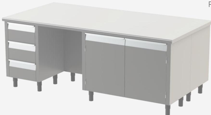
Realizzato in acciaio inox AISI 304 Cr-Ni 18/10, finitura Scotch Brite. Piano di lavoro spessore 12/10 rinforzato e completo di tamponamento inox sottopiano. Bordi frontali raggianti R10, laterali R2.
