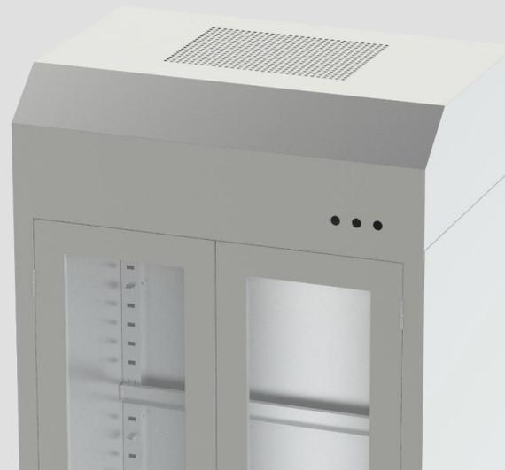
Fabricado en acero inoxidable AISI 304, acabado exterior Scotch Brite. Con dos puertas batientes con bastidor de acero inoxidable y cristal de seguridad de 3+3mm o policarbonato transparente de 6 mm, con 3 estantes interiores perforados regulables en altura, de acero inoxidable AISI 316. Sobre patas telescópicas de acero inoxidable. Techo inclinado con unidad de filtro ventilador H14 en el interior, 595x595x425Hmm.
