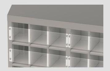
Fabricado en acero inoxidable AISI 304 2B 18/10 Ni-Cr con acabado exterior Scotch Brite. Cerrando los compartimentos abiertos hay paneles desmontables de policarbonato transparente con aberturas frontales superior e inferior para cargar y descargar los consumibles. Ruedas giratorias con soporte de acero inoxidable, dos con freno, las dos traseras son fijas para evitar vuelcos.
