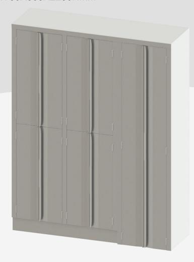
Fabricado en acero inoxidable AISI 304 Ni-Cr 18/10 con acabado Scotch Brite. Completo con 4 compartimentos a la izquierda con 2 puertas abatibles cada uno dim. 600x535x1075 y 1 compartimento a la derecha con 2 puertas abatibles dim. 2150x535x590. Puertas abatibles montadas sobre bisagras desmontables sin necesidad de herramientas mecánicas, cierre magnético. Pies telescópicos de acero inoxidable. Zócalo de cobertura.
